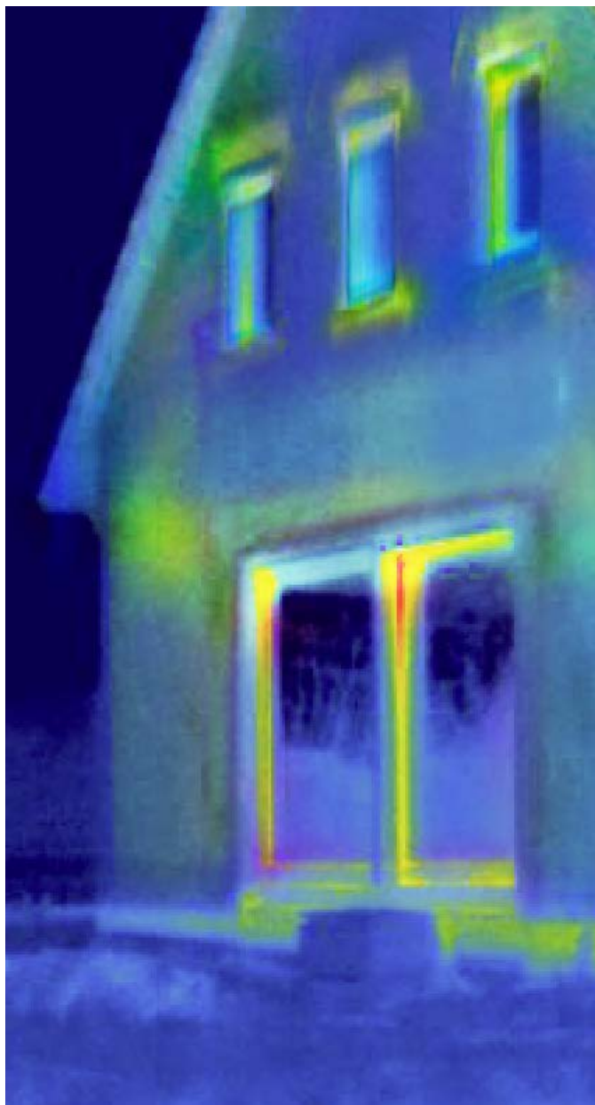
Pred obnovo: velike toplotne izgube so na sliki predstavljene z rdečo barvo
