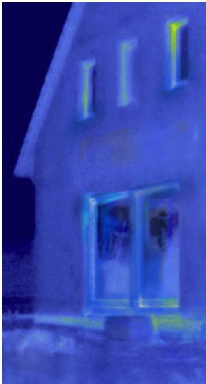
Po obnovi: uporaba dvizno drsnih vrat GENE0 bistveno zmanjša toplotne izgube
